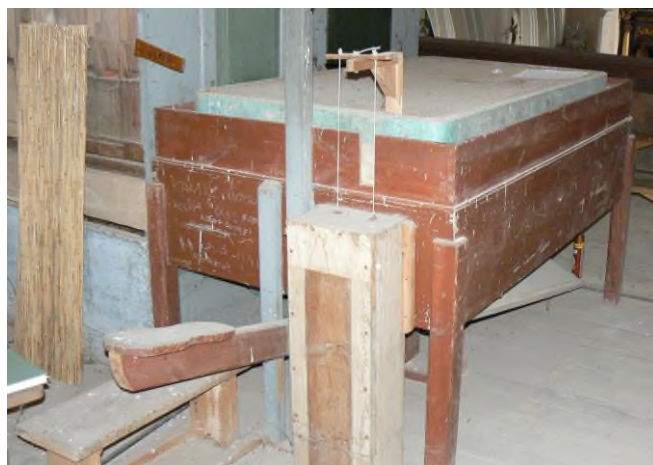
Fot. 34 Miecz pływakowy z dźwignią do kalikowania
