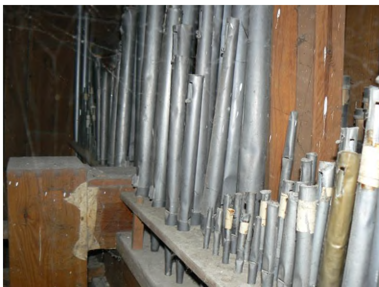
Fot. 59 Piszczalki umieszczone na wiatrownicy
