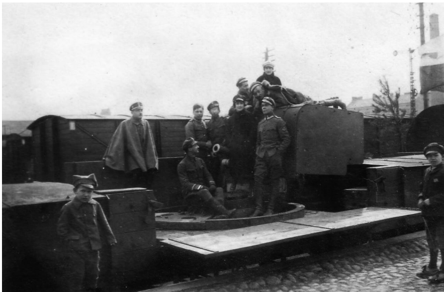
Improwizowany wagon artyleryjski pociągu „Śmiały”. Dobrze widoczny sposób mocowania austriackiej armaty fortecznej 80 mm wz. 05/08 na obrotnicy. Warto zwrócić uwagę na inny kształt osłony armaty aniżeli przedstawiany w dotychczasowej literaturze (zob. J. Magnuski, Pociąg pancerny „Śmiały” w trzech wojnach , Warszawa 1996, s. 16). Przed armatą siedzi por. Michał Münnich. Źródło: zbiory własne autora.
