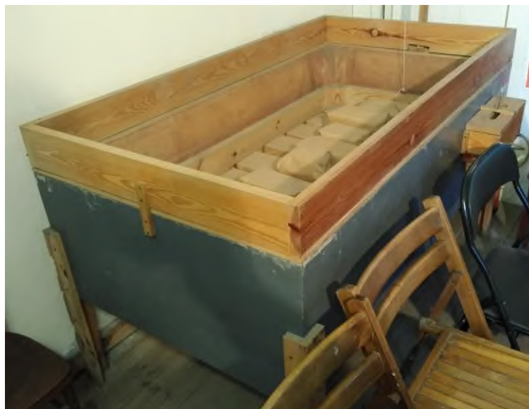
Fot. 113. Miech pływakowy organów w kościele par. w Unikowie.
