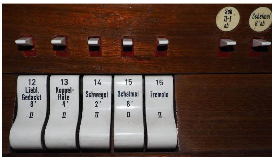
Fot. 93. Kolebkowe włączniki registrów i wyłącznik głosu językowego oraz połączenia Sub II-I w organach w kościele par. w Godynicach.
