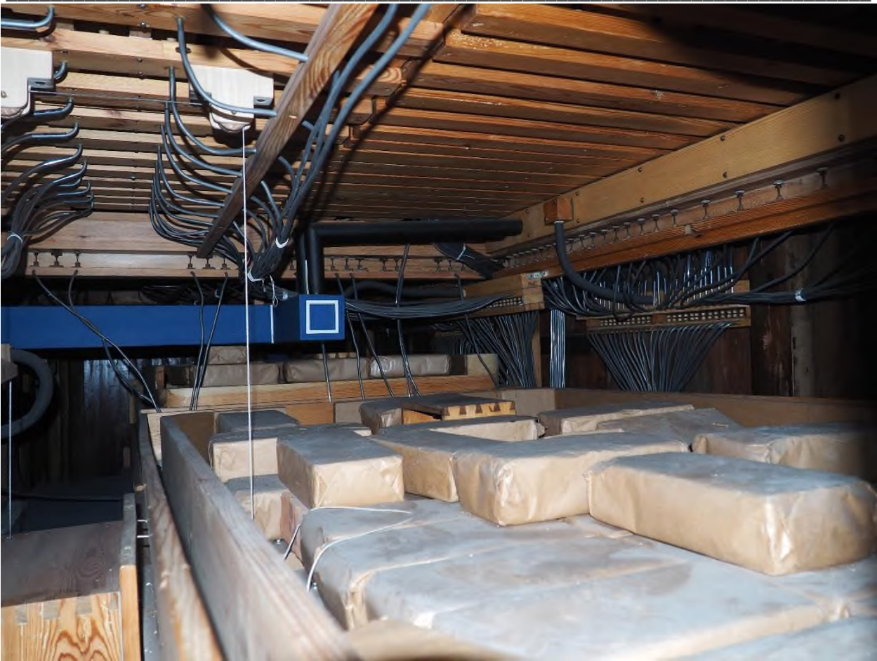
Fot. 50. Górna część miecha organowego, elementy traktury pneumatycznej i dół wiatrownic organów w bazylice mniejszej pw. Wszystkich Świętych w Sieradzu.
