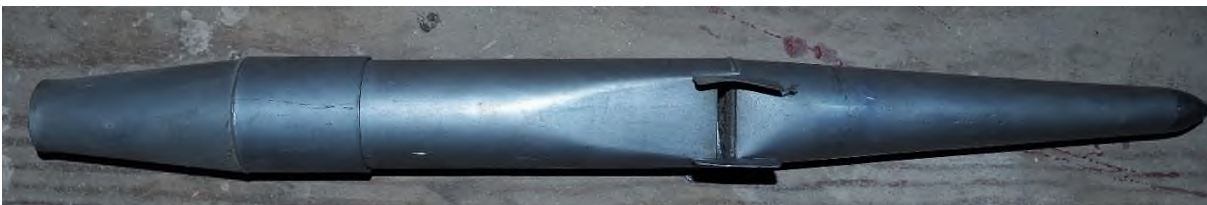
Fot. 95. Koniczna piszczałka głosu Koppelflöte 4' z Manualu II organów w kościele w Godynicach.
