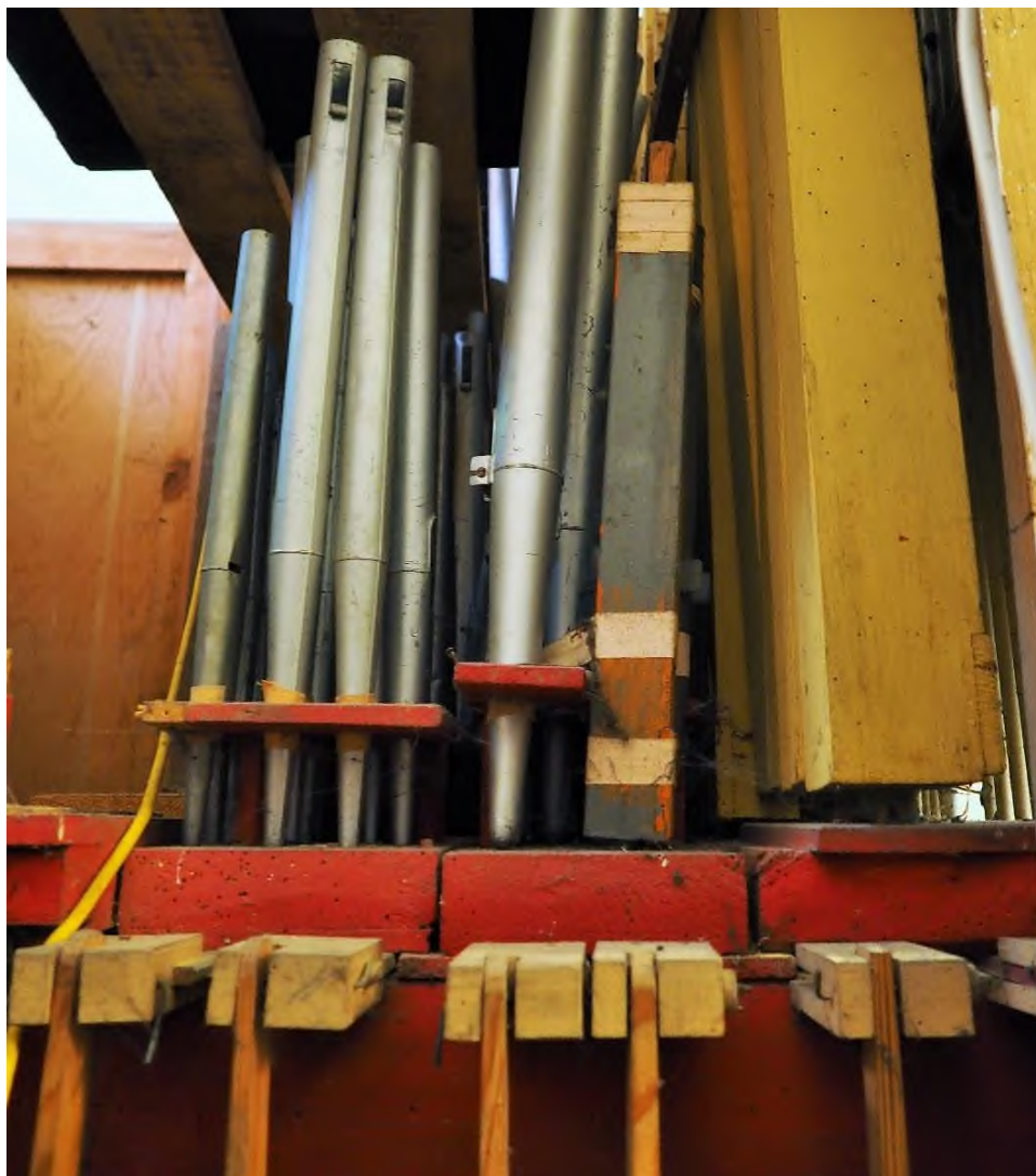
Fot. 106. Piszczalki i zasuw wiatrownicy organów w kościele w Stolcu.
