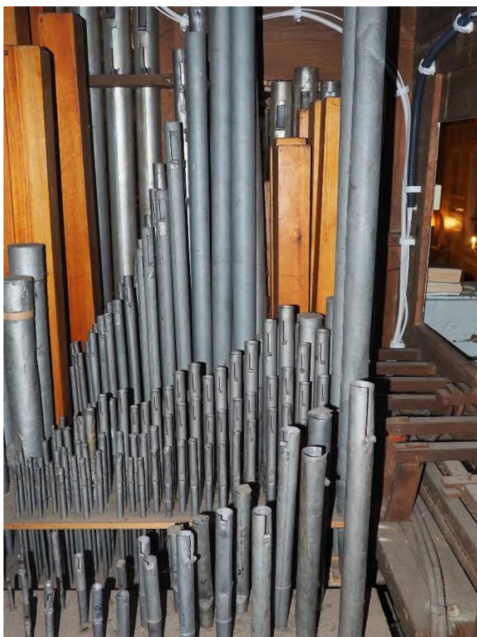
Fot. 44. Na pierwszym planie widok na Flet leśny 2' na wiatrownicy stożkowej, pneumatycznej, w tle pozostałe piszczałki na wiatrownicy klapowo-zasuwowowej, mechanicznej. Organy w kościele w Dąbrowie Wielkiej.
