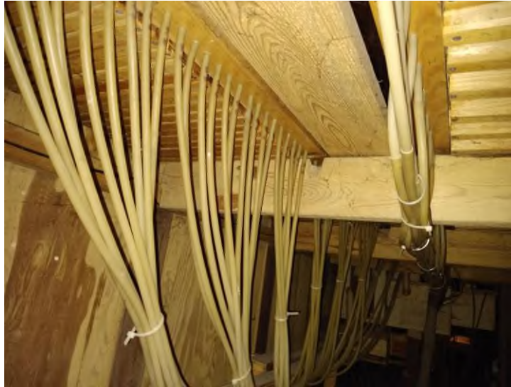
Fot. 111. Spód wiatrownic i elementy traktury pneumatycznej organów w kościele par. w Unikowie.
