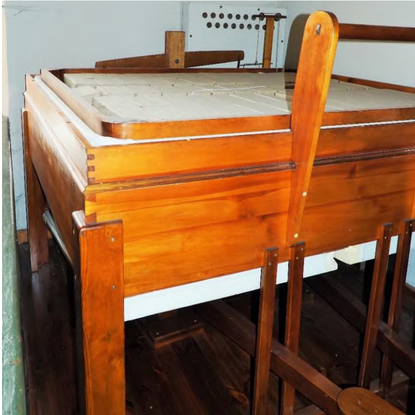
Fot. 56. Miech pływakowy z klinowymi podawaczami w organach w kościele pw. św. Stanisława Bpa w Sieradzu.
