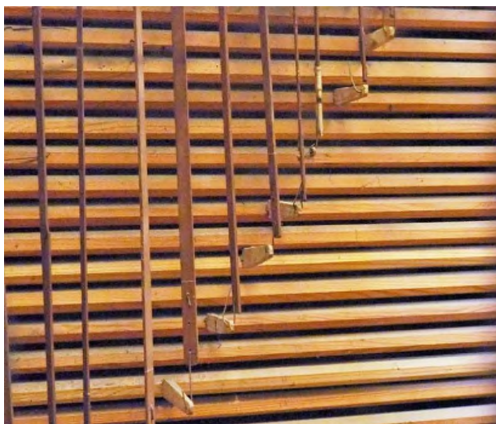
Fot. 104. Fragment deski z wałkami skrętnymi i cięgła traktury mechanicznej organów w kościele w Stolcu.
