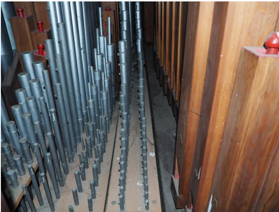
Fot. 39. Piszczalki na wiatrownicy stożkowej organów w kościele w Chojnem.
