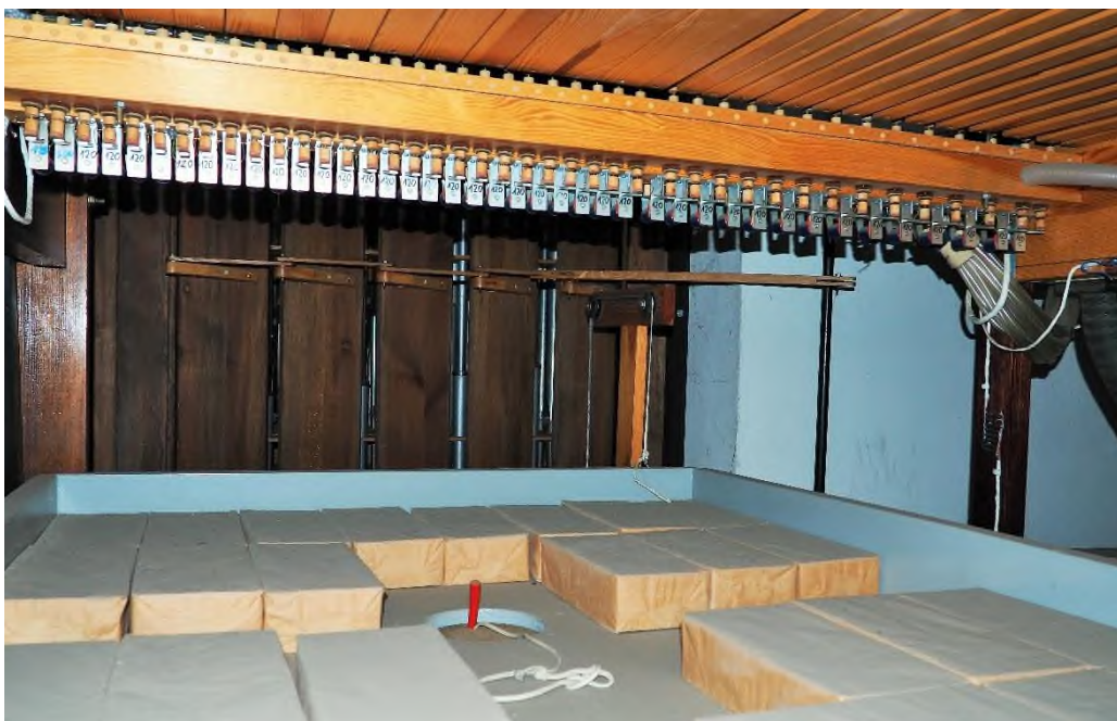
Fot. 64. Widok na sekcję Manuału II: fragment miecha, fragment żaluzji szafy ekspresyjnej, dół wiatrownicy organów w kościele NSJ w Sieradzu.
