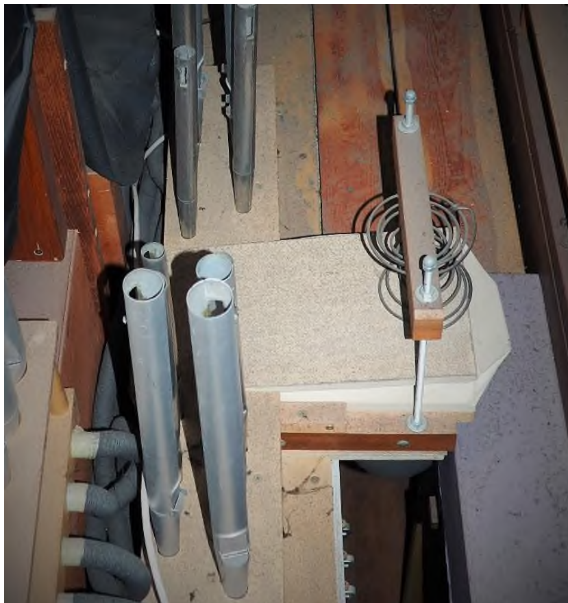
Fot. 86. Mały mieszek klinowy umieszczony za prospektem organów w kościele w Brzeźniu.
