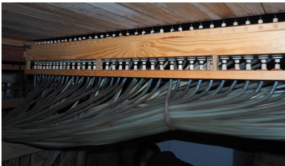
Fot. 78. Pneumatyczna traktura gry organów w kościele w Brąszewicach.
