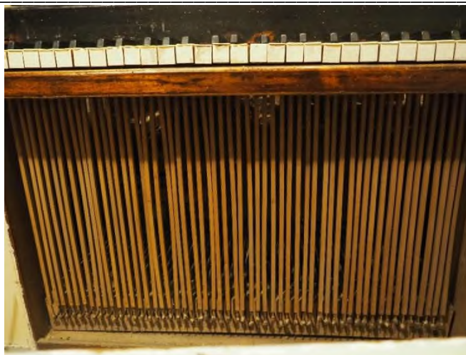
Fot. 43. Ciągła traktury gry pozytywu w kościele w Dąbrowie Wielkiej.
