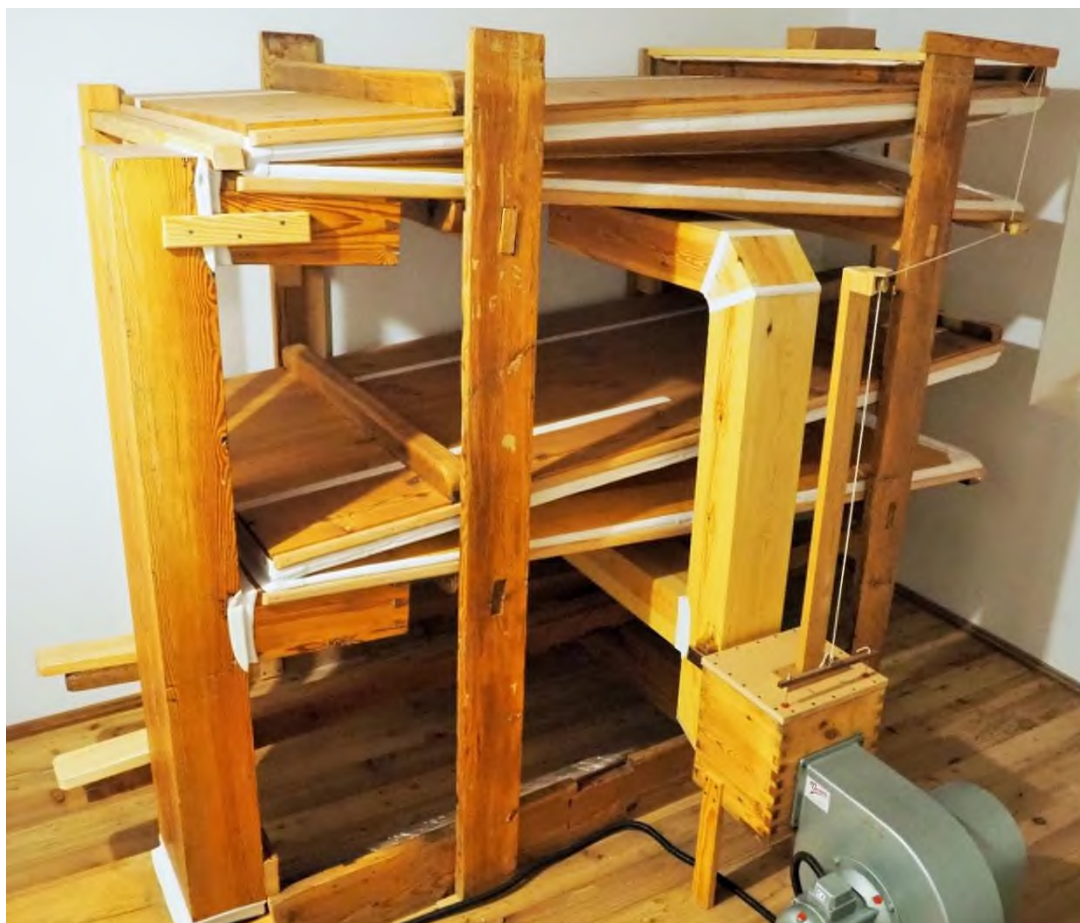
Fot. 120. Dwa miechy klinowe z dmuchawą w organach w kościele par. w Złoczewie.
