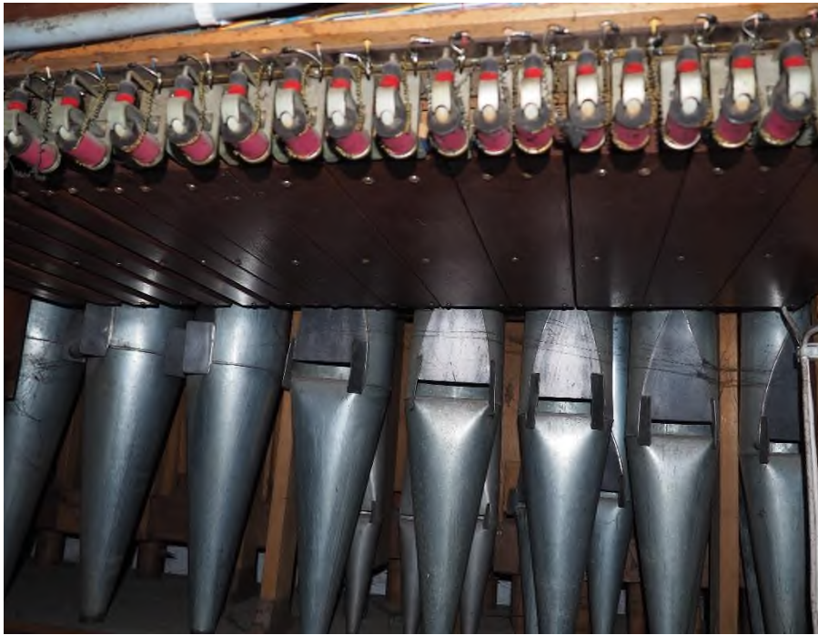
Fot. 94. Dolne fragmenty piszczałek Pedalu i elektromagnesy wiatrownicy Manualu.
