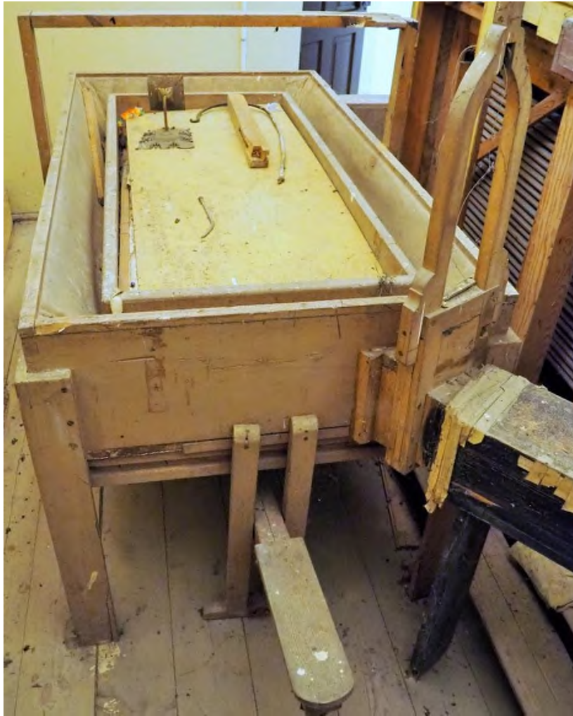
Fot. 107. Miech pływakowy, urządzenie do kalikowania i fragment kanału powietrznego organów w kościele w Stolcu.
