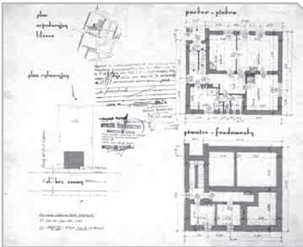
← Projekt domu przy ul. Lisa-Kuli 13 w Lublinie, plan orientacyjny i sytuacyjny, rzut fundamentów i piwnic, rzut parteru – piętra, APL IB, sygn. 2542.
